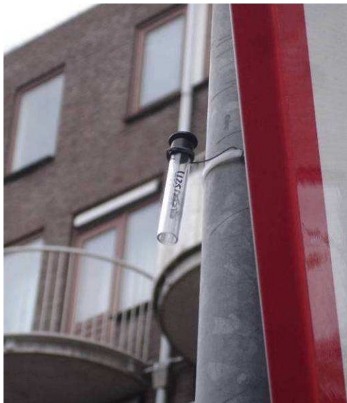
Palmes buisje bevestigd aan verkeersbordpaal
